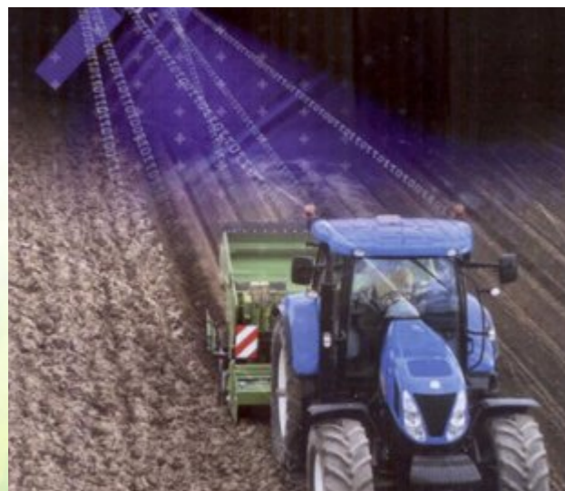
Slika 3: Samodejno vodenje traktorja – saditev krompirja
