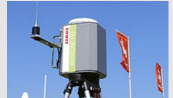
Slika 4: Primer uporabe sistema DGPS v kmetijstvu
