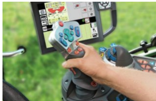
Slika 7: Prikazovalnik stanja – ISOBUS na kmetijskem stroju – trosilnik mineralnih gnojil
